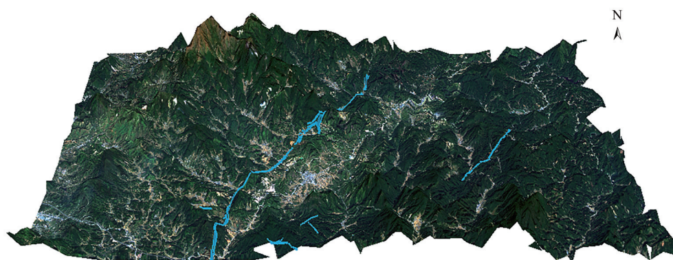
图8 融合后多光谱真彩色三维地形图(蓝色区域为硅化带)
